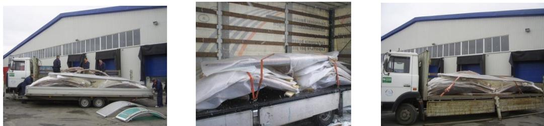
В этом случае высота тента автомобиля не имеет большого значения, но параметры ширины и длины кузова сохраняются. При этом автомобиль должен обязательно быть укомплектован транспортировочными ремнями в количестве не менее 4-х штук.
