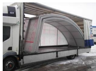
2. После того, как павильон погружен производится его раскрепление. Секции раскрепляются с боков против поперечного хода. В больших павильонах между секций устанавливаются прокладки. Затем на павильон навешиваются его торцевые стенки.
