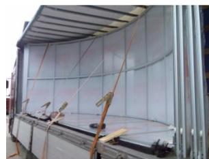
Дно кузова автомобиля должно быть деревянным, для того, чтобы была возможность произвести раскрепление, отвечающее требованиям транспортировки павильона без повреждений.
